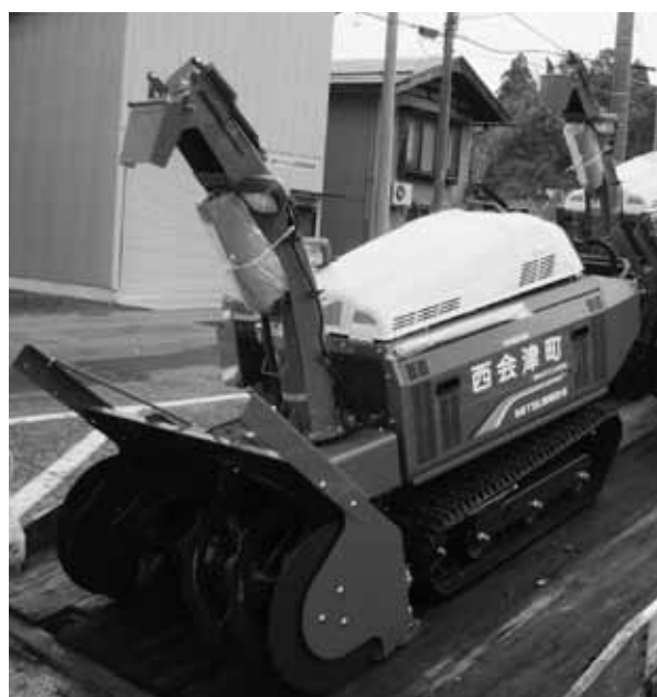
除雪作業車が入れないところは小型除雪機械で
