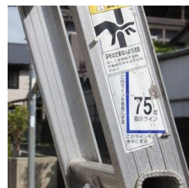
はしごに正しい角度が表示されています
