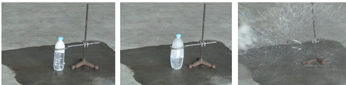
図 2 破裂後のペットボトルの外観 3
