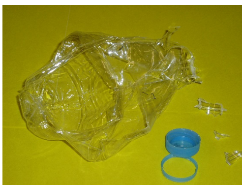
図 2 破裂後のペットボトルの外観 3
