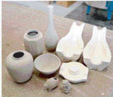
【写真下】素焼前の花瓶・壺などの作品(左側)と粘土を流し込む型(右側3点)／【写真右】型の組み立て作業
