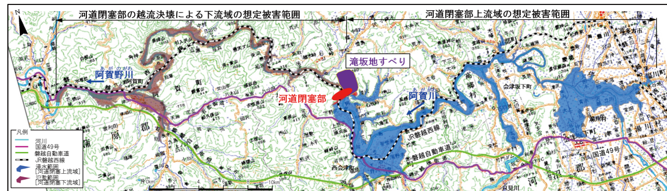
滝坂地すべりの活動により想定される被害範囲（提供：阿賀野川河川事務所）
